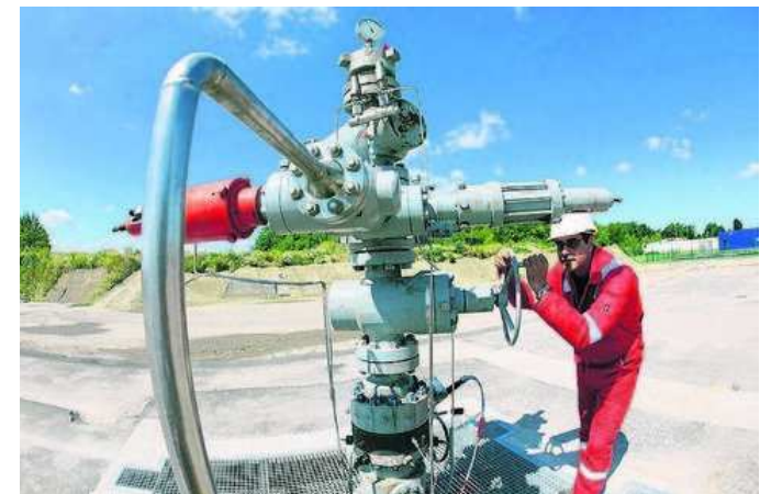
Diplomingenieur Fabian Möller dreht an einem Absperrventil der CO-Speicherbohrung in Ketzin (Havelland). (FOTO: DPA)
